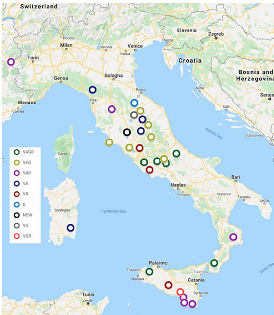
Figura 1 Mappa dei siti della RSN di competenza ONT sui quali sono stati effettuati dei potenziamenti in virtù del presente progetto. Le sigle stazione e i diversi colori sono funzione dei diversi sensori installati in ogni sito: V=velocimetro, A=accelerometro, G=GPS geodetico, R=radonometro. A titolo esemplificativo, VAR sta quindi ad indicare un sito con presenza di velocimetro, accelerometro e radonometro; con NEW vengono indicati i nuovi siti.
