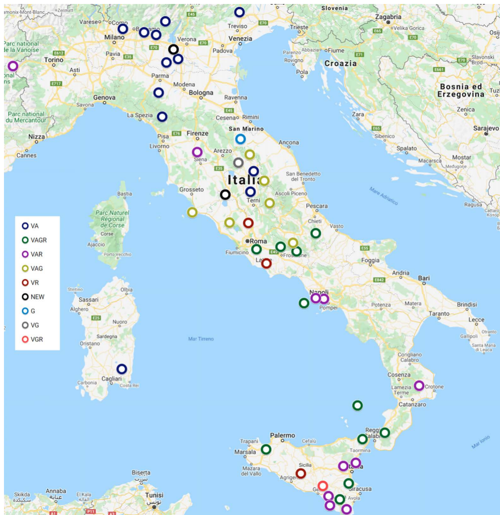
Figura 1 Mappa della rete multiparametrica realizzata. Ogni colore rappresenta la presenza di determinati sensori. V = velocimetro, A = accelerometro, G = GPS geodetico, R = radonometro. “VAR” sta quindi ad indicare una stazione con presenza di velocimetro, accelerometro e radonometro. I nuovi siti invece sono indicati con “NEW” (cerchi in nero).
