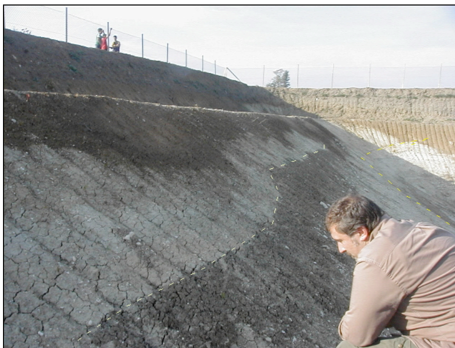
Figura 1. Piani di sovrascorrimento a basso angolo in Marne di S. Agata Fossili sovrastanti a paleosuolo.
